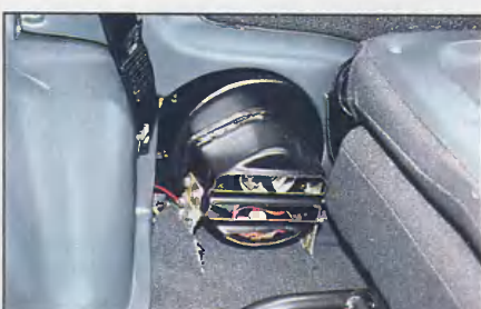
Для второго ряда сидений свой отопитель (для наглядности выдвинут)
