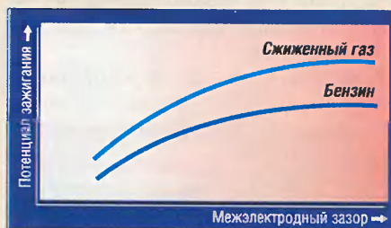
Рис. 3. Зависимость потенциала зажигания от межэлектродного расстояния и вида топлива.
