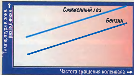
Рис. 4. Зависимость температуры наконечника изолятора от нагрузки и вида топлива.
