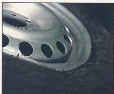
Результат удара по немецкому диску «Мефро» и перламутровому вазовцу (справа).
