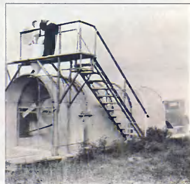
В 1930-м где-то в Америке продували автомобили в чистом поле. Чтобы сделать воздушный поток видимым, перед вентилятором сыпали муку.
