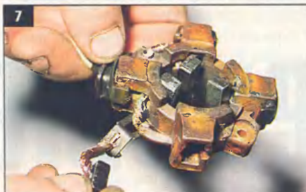
Щетки на стартере с редуктором меняют в сборе.
