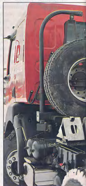
Стокилограммовой запаске – подъемный кран.
