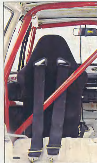
Салон гоночной «Оки». Красные трубы – каркас безопасности.
