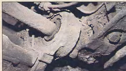
Потрескавшийся сайлент-блок задней балки рано слисывать в утиль.
