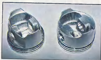
«Тюнинг» поршень легче обычного.
