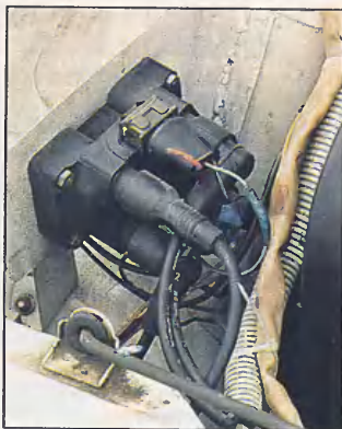
Серийный модуль зажигания уступил место более надежному.
