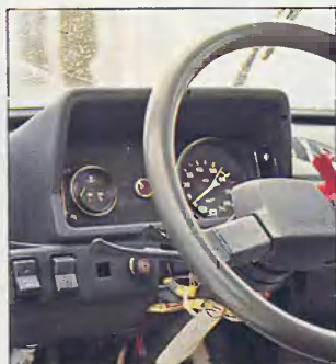
Вместо штатных приборов – тахометр и указатель температуры двигателя.
