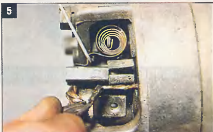
Вынимаем щетку, пружину оттягиваем крючком.
