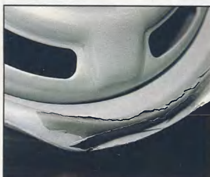
Результат удара по немецкому диску «Мефро» и перламутровому вазовцу (справа).
