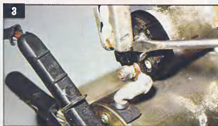
Предварительная проверка демонтированного стартера.
