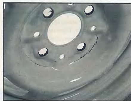
Кременчугское колесо испытаний на усталость не выдержало.
