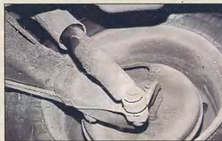
Сильный наклон амортизаторов – виновник стуков при «перекладке» поршня.
