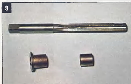
Втулки обрабатываем разверткой.
