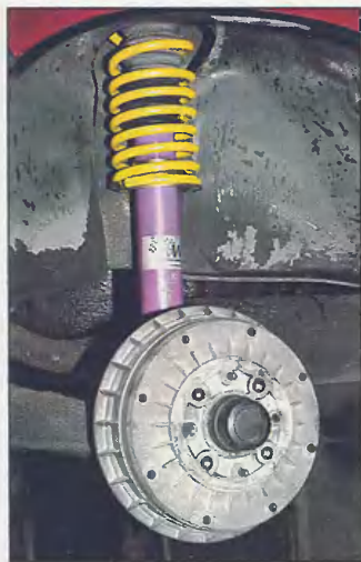
Такая стойка снижает проходимость, но улучшает управляемость.
