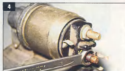
Ослабленную клемму затягиваем первой гайкой.
