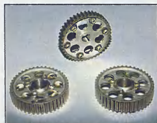
Разрезные шестерни нужны для подгонки фаз.
